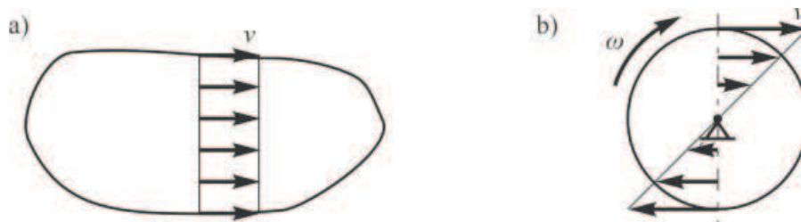
Bild 2-10 Unterscheidung zwischen Translation und Rotation beim starren Körper a) Translation: Geschwindigkeit v ist für alle Punkte des SK gleich b) Rotation: Winkelgeschwindigkeit \omega ist für alle Punkte des SK gleich
