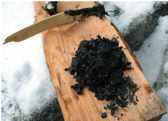
Abb. 1.1 Im Entopfverfahren hergestelltes Birkenpech (Foto: Jorre, Wikimedia Commons).
