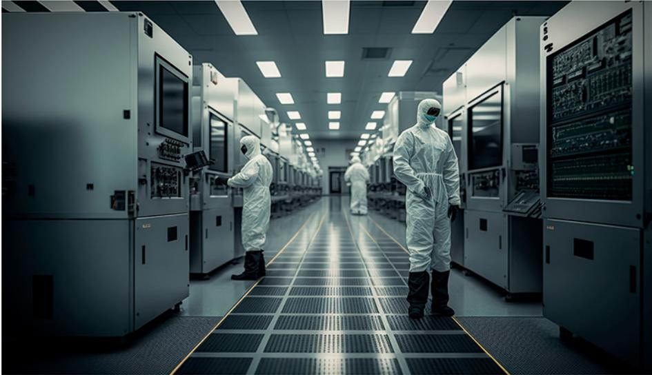
**Bild 1.3** Reinraumtechnische Fertigungsstraße: eine automatische Fertigungslinie mit einer Serie von hermetisch dichten Isolatoren zur Herstellung von Halbleiterbausteinen. Foto: AdobeStock
