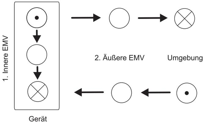
**Bild 2.4** Unterscheidung innere und äußere EMV: Die EMV innerhalb eines Produktes, Systems oder Gerätes liegt allein in der Verantwortung des Herstellers, der die Funktion seines Gerätes im eigenen Interesse sicherstellen muss – die EMV zwischen einem Gerät und den anderen Geräten und Systemen in seiner Umgebung ist an die Vorgaben aus dem EMV-Gesetz gebunden und obliegt der Aufsicht durch die Bundesnetzagentur (BNetzA).
