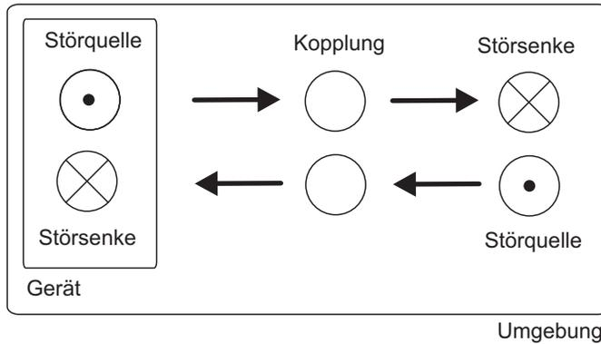
**Bild 2.2** Elementares EMV-Modell: Alle Geräte sind prinzipiell Quelle und Senke für elektromagnetische Störphänomene, sie interagieren über Kopplungsmechanismen mit Quellen und Senken in ihrer Umgebung.
