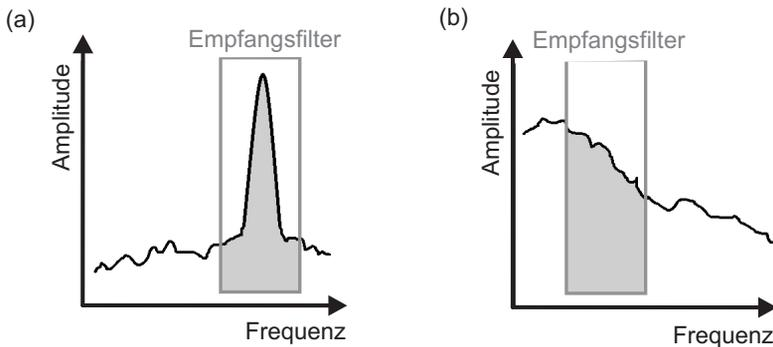
**Bild 2.5** Spektrum von (a) schmalbandigen und (b) breitbandigen Störquellen: Das schmalbandige Signal kann einem beschränkten Frequenzbereich zugeordnet werden und ist schmäler als das Empfangsfilter – das breitbandige Signal belegt ein breites Spektrum und ist breiter als das Empfangsfilter.
