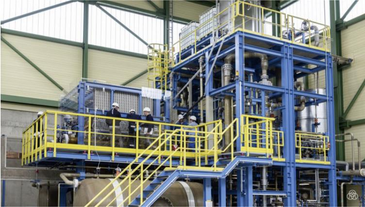
**Bild 1.10** Elektrolytische Anlagen im Industriemassstab – hier die alkalische Elektrolyseanlage von thyssenkrupp Uhde Chlorine Engineering GmbH im Duisburger Stahlwerk von thyssenkrupp Steel – helfen bei der klimaneutralen Umstellung der europäischen Stahlproduktion
