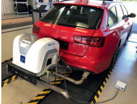
Bild 1.10: Abgastest im Fahrbetrieb [KBA 22]
