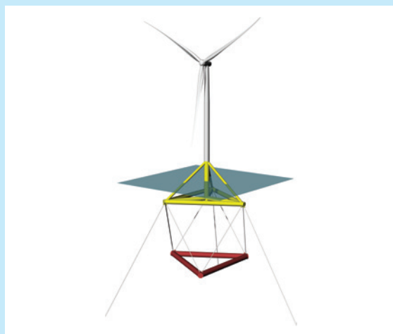
Bild 8.7 Henrik Stiesdals Tetra-Spar-Konzept soll deutlich weniger Stahl verbrauchen als andere Schwimmer. Quelle: Stiesdal Offshore Technologies A/S
