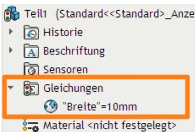
**Bild 2.44:** Globale Variable werden im FeatureManager unter *Gleichungen* geführt.
