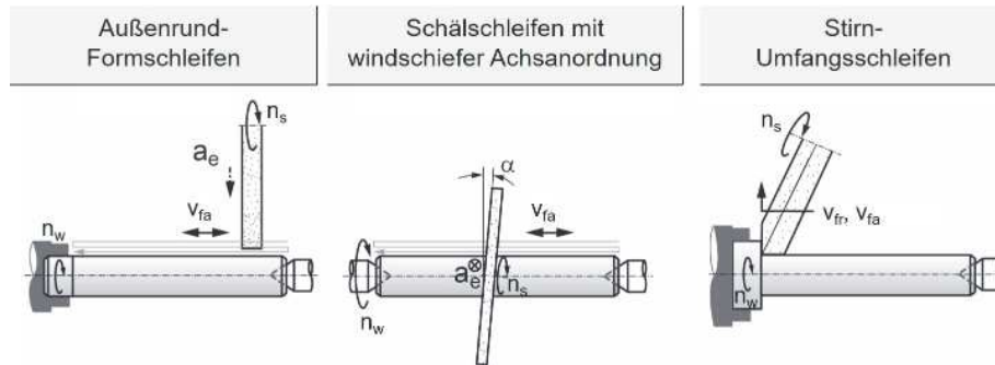
Bild 3.11 Längs-Außen-Rundschleifverfahren
