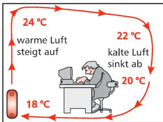
**Bild 1.12:** Wärmetransport in einem Raum durch freie Konvektion.
