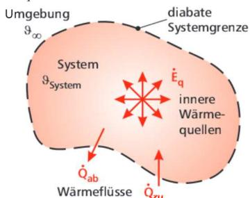
**Bild 1.5:** Wärmeübertragung durch Wärmeflüsse über eine diatherme Systemgrenze.
