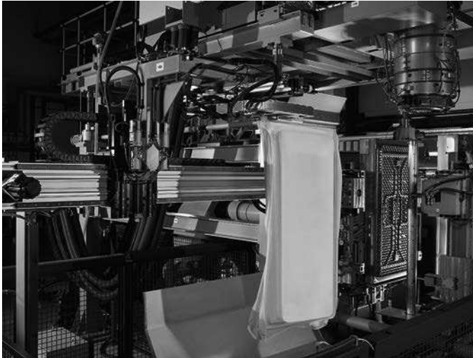
Bild 1.9 Extrusionsblasgeformtes flaches Panel (Tischplatte) (Bild: Kautex Maschinenbau)
