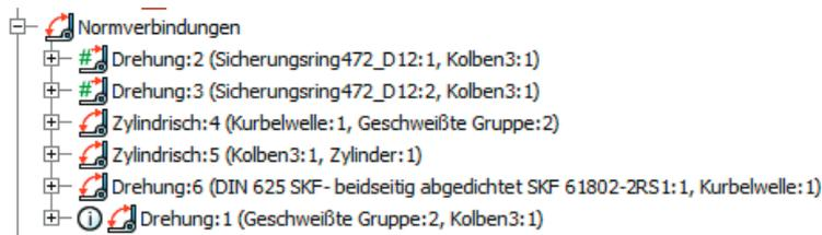
Das zuletzt angezeigte Gelenk, DREHUNG:1, zwischen der Pleuel-Baugruppe und dem Kolben, wird als *Redundant* (überbestimmt) angezeigt und soll deswegen näher untersucht werden.
