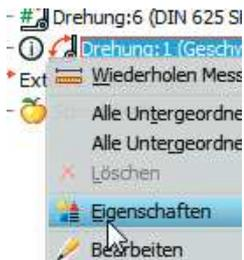
Im Dialogfenster **EIGENSCHAFTEN** dieses Gelenks selektieren Sie die Registerkarte **FREIHEITSGRAD 1 (R)** und auf dieser den mittleren Button **GELENKDREHMOMENT BEARBEITEN**. Nun wählen Sie das Optionsfeld **GELENKDREHMOMENT AKTIVIEREN** aus und tragen als **KOEFFIZIENT** der Reibung z.B. den Wert 0,1 ein. Der Kolbenbolzen hat einen Durchmesser von 12 mm, weswegen Sie den **REIBRADIUS** mit 6 MM angeben müssen. Die Eingaben bestätigen Sie mit **OK**.
