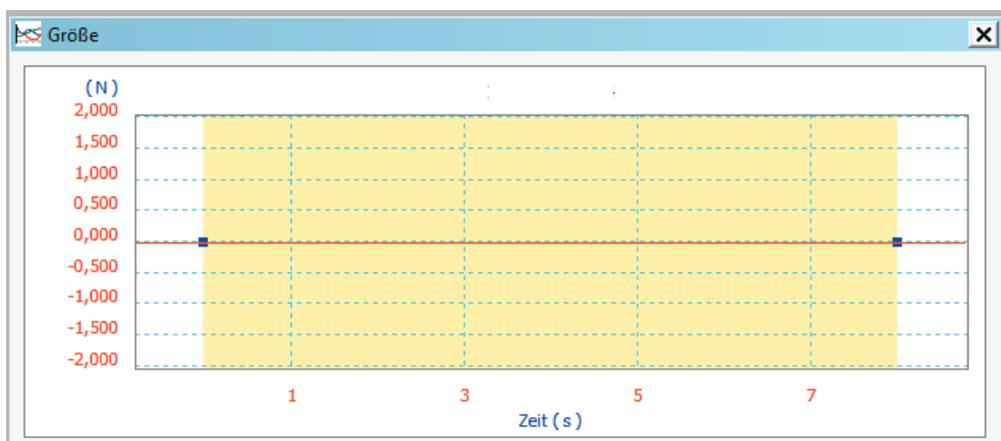
Es empfiehlt sich sehr, die eingetragenen Punkte sofort zu sperren, da sich sonst beim Verändern eines Punktes die anderen meist mit verstellen. Die Kontextmenüfunktion eines Punktes, **PUNKT SPERREN**, versieht den betreffenden Punkt im Diagramm mit einem Anker-Symbol, lässt aber weiterhin zu, die Zeit- und Kraftwerte dieses Punktes über die Eingabefelder zu definieren.
