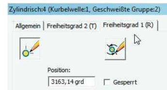
Das Rotationsgelenk ist dagegen direkt an der Simulation beteiligt und muss mit einem *Reibungskoeffizienten* ausgestattet werden.
