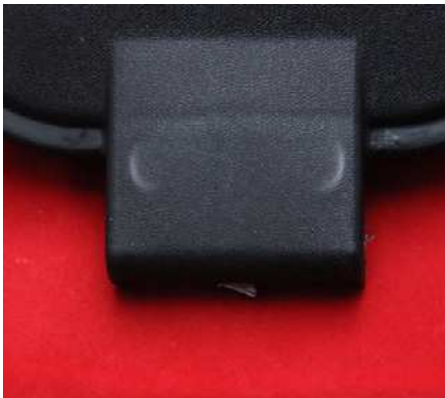
Bild 29.22 Sichtbare Auswerfermarkierungen, die wie weiße Mondsicheln aussehen. Außerdem ist eine deutliche Einfallstelle zu erkennen.
