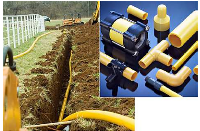
Bild 6.10 Diese Gasrohrleitungen und Armaturen für Gasleitungen werden aus Rilsan PA11 für den Einsatz in Erdgasdrucksysteme mit Abmessungen bis zu 100 mm Durchmesser und Betriebsdrücke von bis zu 14 bar hergestellt. Dieses Material wird vollständig aus erneuerbaren Quellen erzeugt. [Quelle: Arkema]
