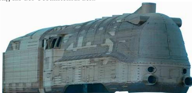
**Bild 4.18** Modell einer Spielzeug-Dampflokomotive Maßstab G (1 : 22,5), Laminated Object Manufacturing (LOM); Papier; Nachbehandlung mittels Lasur, ansonsten unbearbeitet
