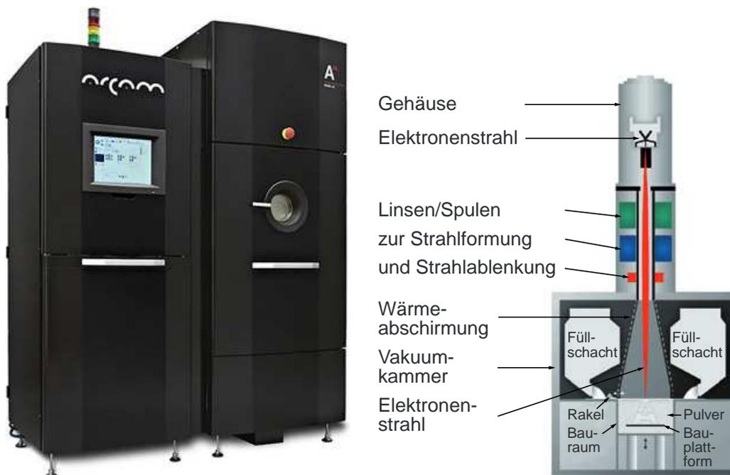
**Bild 2.16** Elektronenstrahl-Schmelzen (EBM): ARCAM A2X (links), EBM Funktionsschema (rechts) (Quelle: ARCAM)
