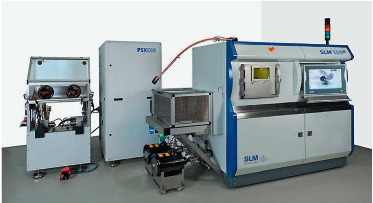
**Bild 3.13** SLM<sup>®</sup> 500 HL Laserschmelzanlage mit Auspackstation PRS (links im Bild) und Pulversiebstation (in der Mitte des Bildes)
