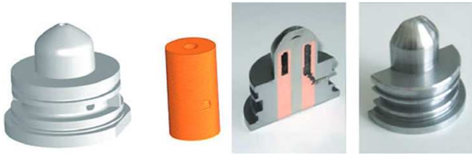
Bild 5.3 Melato. Werkzeugeinsatz aus Stahl und Kupfer. CAD-Konstruktion (ganz links und links), endbearbeitetes Werkzeug (ganz rechts) und aufgeschnittener Einsatz mit Blick auf die Kühlzone (rechts)
