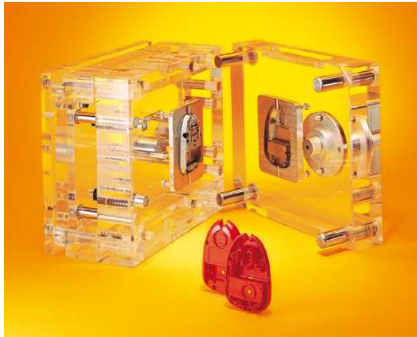
Bild 5.5 Prinzipieller Aufbau eines Spritzgießwerkzeugs Die Platten wurden zur Demonstration aus Plexiglas gefertigt. Quelle: 3D Systems
