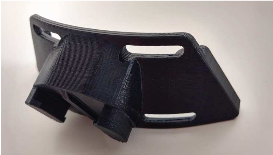
Bild 3.3 FLM-gedruckter Prototyp (Druckzeit: 40 Minuten)
