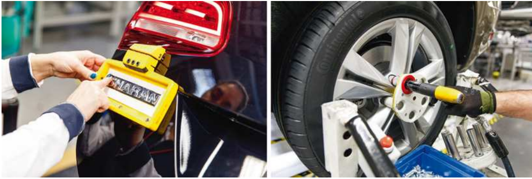
Bild 3.6 Mit Geräten von Ultimaker 3D-gedruckte Schablone (links) und Felgenschutz in der Montage bei VW Autoeuropa (© Ultimaker)
