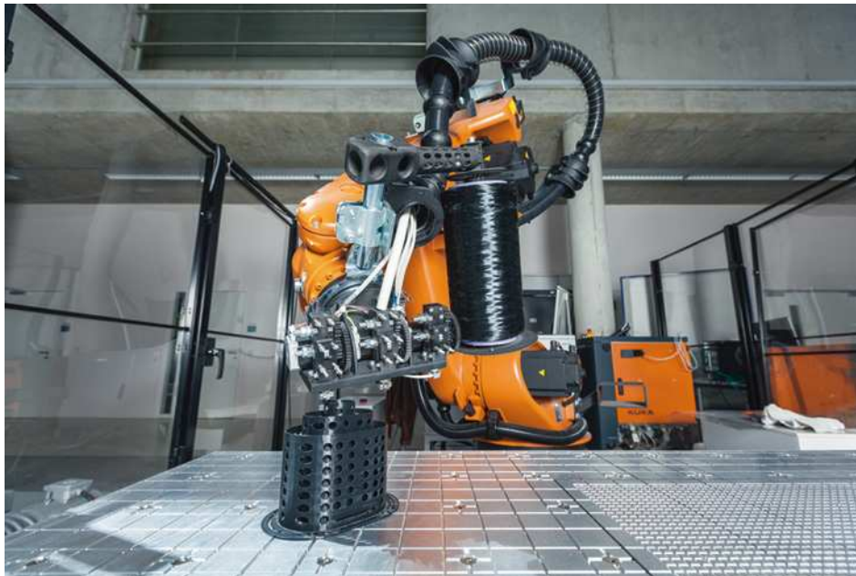
Bild 2.14 3D Fibre PrinteR mit drei FLM-Extrudern und Aramidfaserintegration (Quelle: Fraunhofer IPA)
