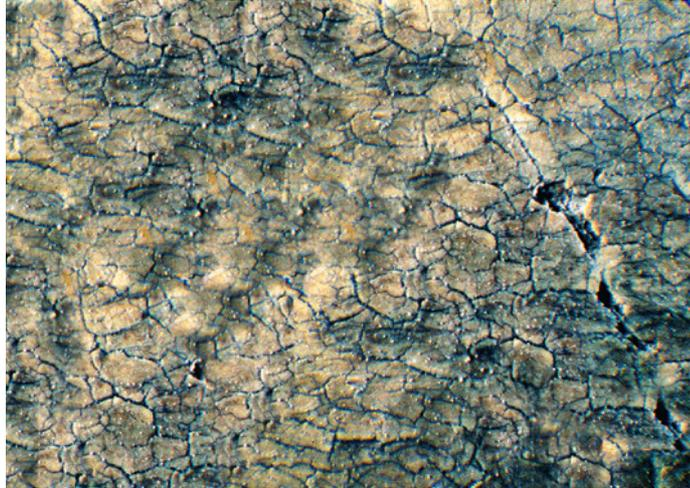
Bild 415, POM-Schaltergehäuse (V<sub>30</sub>, AL) mit starker Alterung und dem typischen Bild einer Hydrolyse. Die Oberfläche löste sich auf in hügelige Strukturen und bekam dazwischen tiefe Risse. Es gibt besonders hydrolyseempfindliche POM-Sorten, deren Oberflächen durch Feuchtigkeit und Wasser bei Temperaturen ab 60°C angegriffen werden.
