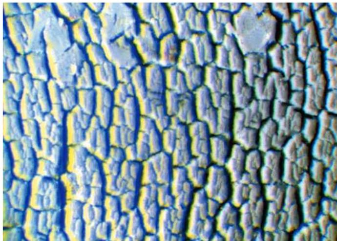
Bild 416, POM-Oberfläche eines Kranschalters (V<sub>33</sub>, AL) mit starker Alterung. Die Oberflächezersetzung begann nach etwa fünf Jahren unter Feuchtigkeits- und Schmierölneinfluss. Dabei entstanden sehr viele und tiefe insuläre Risse. Während der Gebrauchsdauer wurde vom Auftraggeber auch ein erhöhter Temperatureinfluss von bis zu 65°C gemessen. Daher vermuten wir eine hydrolytische Zersetzung in Verbindung mit einem Schmierölneinfluss.
