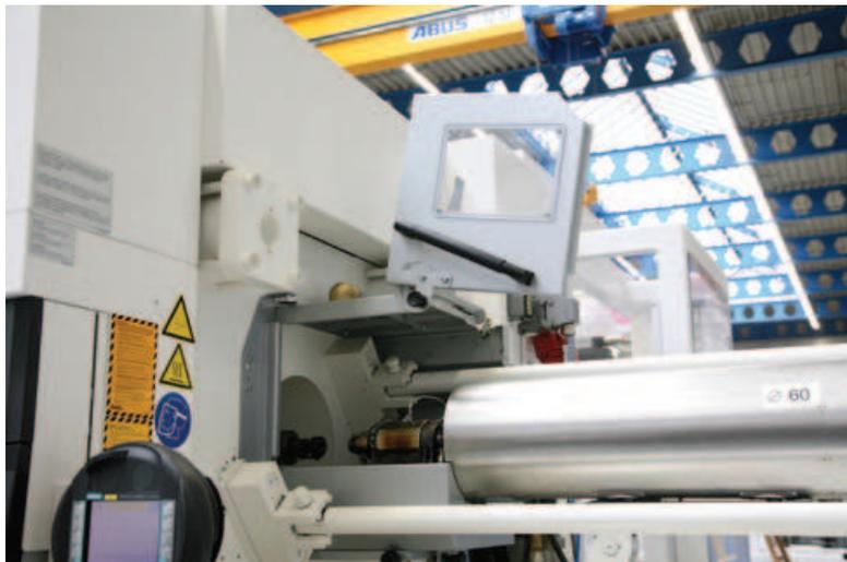
**BILD 5.14** Massezylinderabsaugung [Bildquelle: ENGEL AUSTRIA GmbH]
