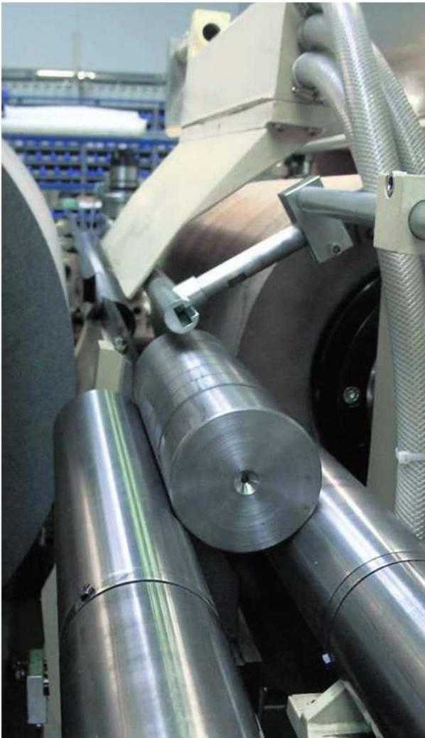
Abb. 13.211: Zweiwalzenzuführung (Quelle: Schaudt Mikrosa GmbH)
