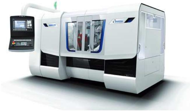
Abb. 13.198: Gesamtansicht einer spitzenlosen Außenrundschleifmaschine (Quelle: Schaudt Mikrosa GmbH)
