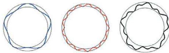
Abb. 13.180: Überlagerung von Polygonen (Quelle: Schaudt Mikrosa GmbH)
