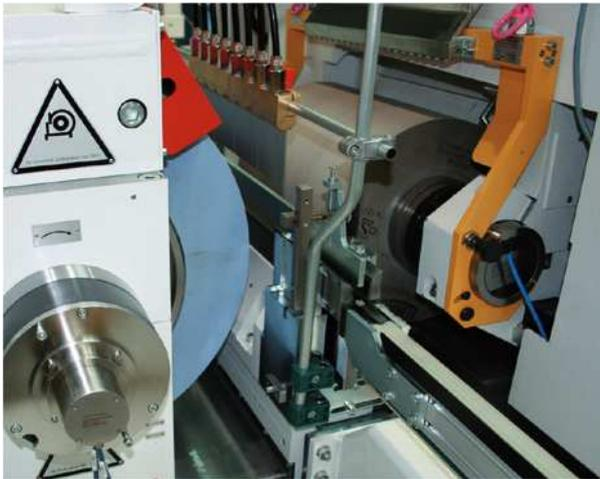
Abb. 13.203: Maschinenarbeitsraum für das Durchgangsschleifen (Quelle: Schaudt Mikrosa GmbH)
