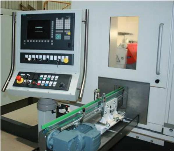
Abb. 13.209: Flachbandzuführung (Quelle: Schaudt Mikrosa GmbH)
