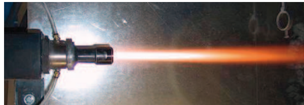
Abb. 4.42: HVOF-Freistrahler eines Kerosinbrenners mit Pulver (WC/Co 88/12)
